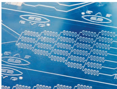
ホットエンボスによりPMMAで複製されたマイクロ流体チップ 提供: EVG
